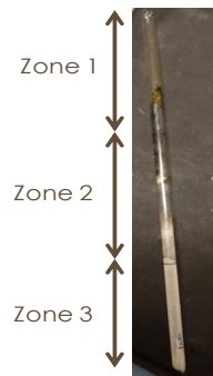
図3. 1000°Cに加熱後の石英管の飛散物分布の写真
