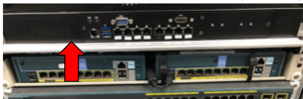
図 3 動的ゾーニング用 Open vSwitch ( タグアウトシステム )
