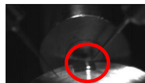
図9 GaAs 1-x Bi x レーザダイオードの構造と発光の様子。写真の中の赤丸の中がレーザダイオードからの発光(赤外像)。
