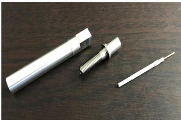
【図1】導電性薄膜ストローを飛跡検出器として実装するために開発したプラグ部品
