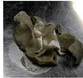
図5: 実験後の攪拌供試体
