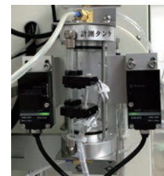
図3: 膨潤量の計測部分
