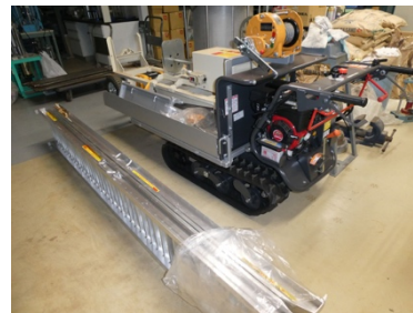
図-2(b) 開発した斜面走行型 SWS
