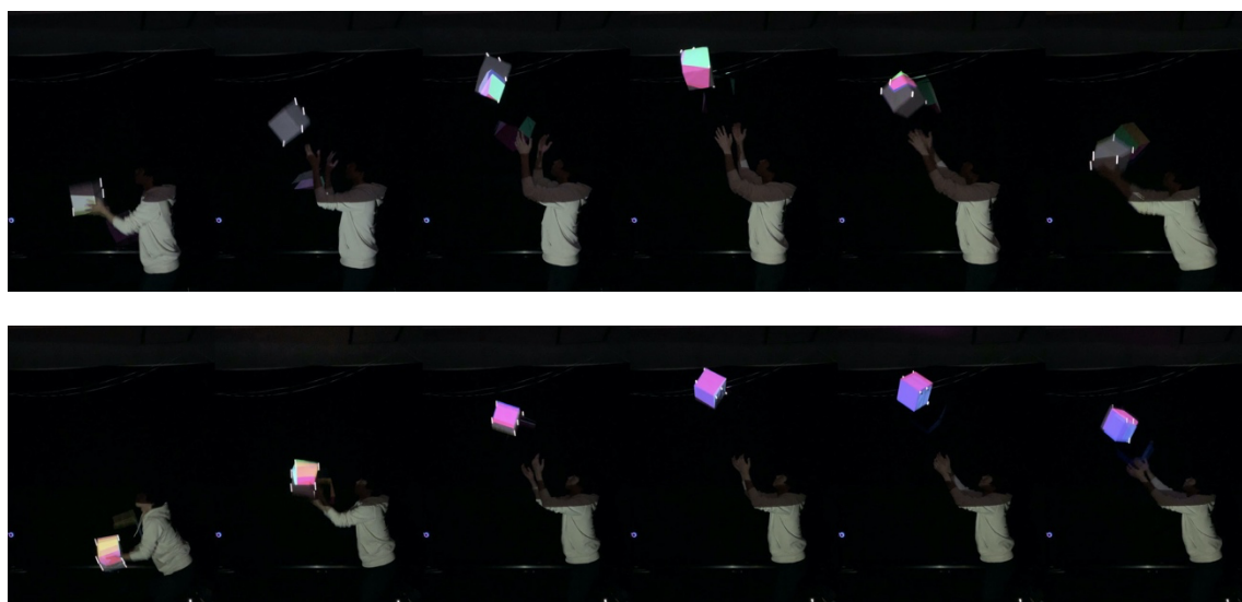
図3：投影結果の比較。(上) 予測なし。(下) 深層学習による予測あり。
