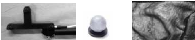
図1 光学式マーカの例（左：赤外LEDマーカ，中央：反射式マーカ）と提案するtextured形状計測の例（右：胃内壁）
