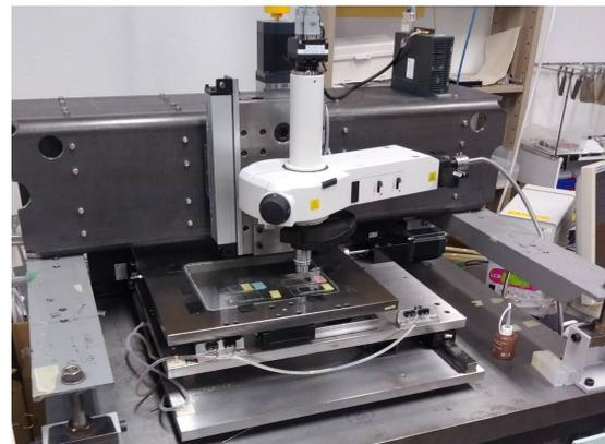
図 2. 本研究で開発した超微粒子原子核乾板解析用顕微鏡システム
