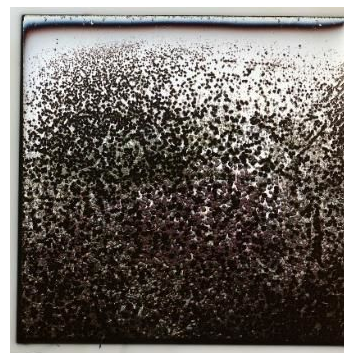
図1：ダイヤモンド合成後微分干渉写真。サイズは8mmx8mm。メタン濃度0.20%で製作した。
