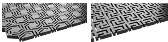
図 1. 負の屈折を起こすシリコン薄板フォノンニックメタマテリアル構造の例
