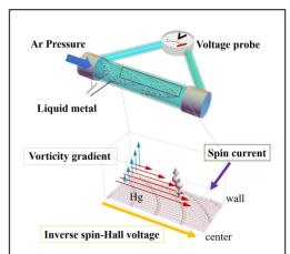
図 1:スピン流体発電の模式図。微細管に流体を流すことで生じる渦度勾配が スピン流を作り、それを逆スピンホール効果を通じて電圧として測定する。
