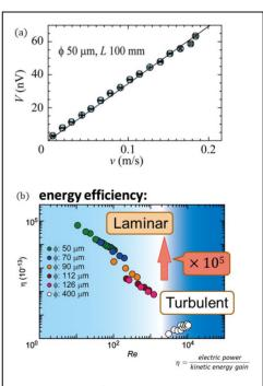
図4:層流スピン流体発電効果。(a)発生電圧は流速に比例する。(b)層流における発電効率が乱流の10万倍に増大した。
