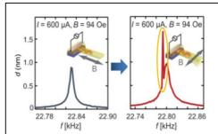
図5:スピン流注入によるカンチレバーの振動スペクトル。カンチレバーに対して平行な磁場を加えた際には熱振動のみが観測されたのに対し、カンチレバーと垂直に磁場を加えると明瞭なスピン流シグナルが観測された。
