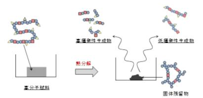
著しい高性能化などにより、それらの精密な解析が可能になっている。その一方で、従来の熱分解 GC で解析できるのは、揮発性成分のみを測定対象とする GC 分析の原理から、高揮発性分解生成物にほぼ限定されていた。しかし、潜在的には、高分子量成分や強極性成分なども含む b の低揮発性分解生成物が、最も有用な化学構造情報を有していると考えられる。にもかかわらず、測定原理上の制約から、b.の生成物は従来の熱分解 GC においては分析対象とされないままであった。一方、c.の固体残留物については、一般に反応が過度に進行して、本来の化学構造情報が失われている可能性が高いため、ほとんど有用性はなく、むしろ生成しないことが望ましい。
