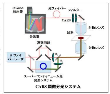
け、一方をフォトニック結晶ファイバーによるスーパーコンティニウム(SC)光発生システム に導入して SC 光を発生させた。SC 光の波長成分のうち、近赤外成分をフィルターで分離して 広帯域ストークス光 ( $\omega_2=1250\pm250~\text{nm}$ ) として用い、ファイバーレーザの残りの基本波をバンドパスフィルターにより狭帯域化してポンプ光 ( $\omega_1=1040~\text{nm}$ ) とした。どちらの系統とも、ロングパスフィルターを用いてポンプ光とストークス光を混合して同軸で顕微鏡へ導入し、対物 レンズにより試料に集光した。試料から発生した CARS 光は、対向させた対物レンズで集め、各種フィルターを経由させてポンプ光とストークス光を除いた後に、分光器で分け電子増幅冷却 CCD 検出器で測定した。
