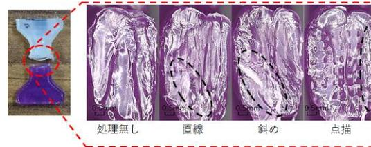
図6 破断面観察結果
