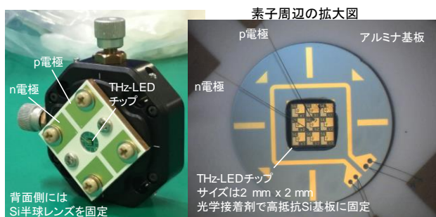
図 2. 試料ホルダにマウントした素子。
