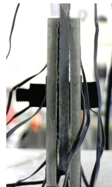
(c) 接着剥離後にボルトの支圧力による母板の破壊
