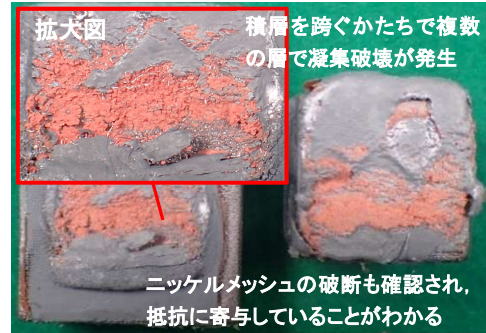
図-17 PUS_NI+Z (5 体目)の荷重後の状況
