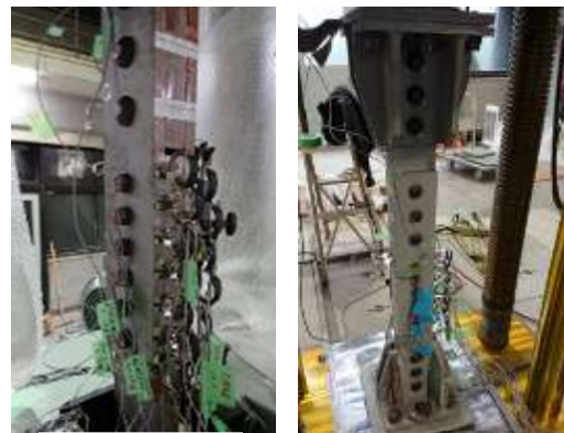
図-3 山形継手・テーパー継手の载荷試験
