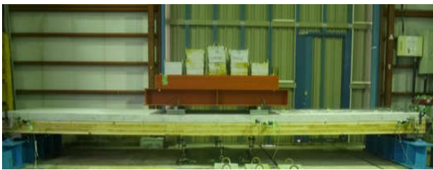
図 7 実大床試験の様子
