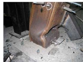
写真1 縮小18層鉄骨造試験体柱脚の局部座屈
