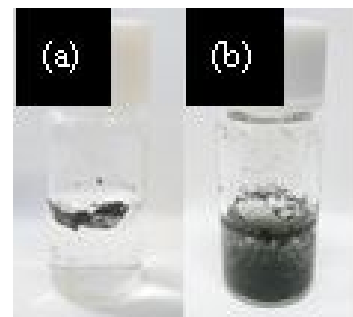
図 4 水に浸漬した (a)CNF と (b)N 導入 CNF
