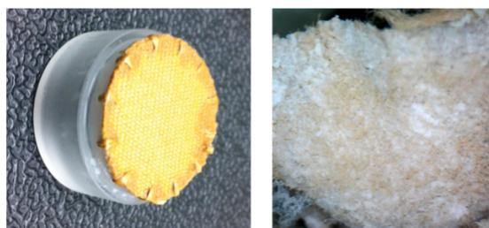
図5 布材料がダスト雲を通過する際のダメージに関する実験結果の例（左：布面飛翔体（射出前）、右：回収後の布部分の拡大写真）
