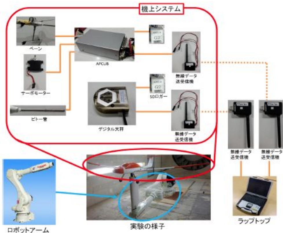
図 8 産業用ロボットアームを用いた風洞試験システム
