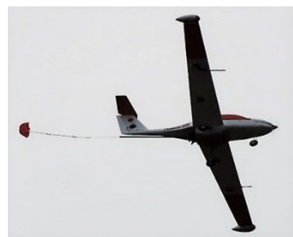
図 7 Parachute Sting Balance による飛行の様子
