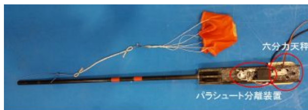
図 6 Parachute Sting Balance 外観
