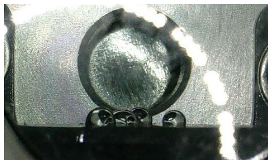
図8 油 水 - 硫化鉱物系の接触角測定の結果 (左) 及び液滴画像の例 (右)
