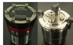
SUS304 製の容器とボールを使用した。SUS304 を構成する金属成分の効果確認等の目的で、必要に応じて、ジルコニア製そしてメノー製の容器とボールを使い分けた。
