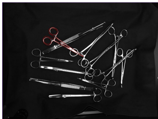
図4 バラ置きされた手術器具内のペアンに対する立体画像識別
