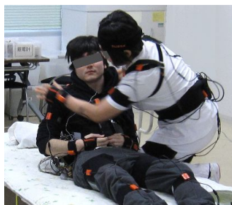
(a) ベッド起き上がり介助 【モーションキャプチャーと EMG デバイス】
