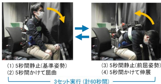
図3：体幹部用試作機装着状態での前屈運動への追従性評価実験のシナリオ
