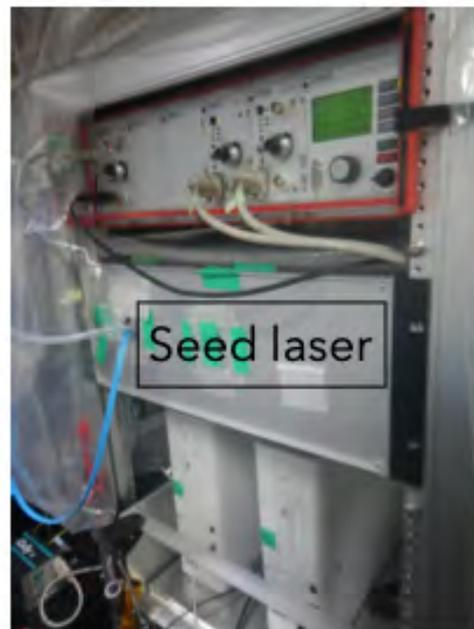
図 2. 送信レーザー波長制御用の狭線幅レーザーシステム。
