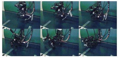
物を回避する緊急停止動作を実現した.高速ビジュアルフィードバックをロボット自身のバランス制御だけではなく環境に対する適応動作へも並列的に遂行できることを実証した.高速画
