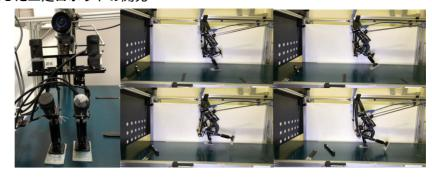
ライバも電流ループ制御の設定,サーマルエラー動作設定など下位レベルから最適化をおこない,アクチュエータの性能を最大限に引き出せるようにすることで,従来以上の高トルクを実現した.プロトタイプでは環境設置型の高速ビジョンシステムが600fpsで動作していたが,本研究では二足ロボット本体に小型高速ビジョンを搭載した走行機構を開発し,1000fpsの画像処理システムを実現した.これにより,走行中の動的なロボット視点および環境に固定された視点の両方において,ロボットの絶対姿勢および路面状況や障害物などの周辺環境をミリ秒オーダで認識しながら,瞬時加速の応答行動が可能な二足走行システムを開発した.
