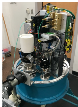
図 10 : NASA/GSFC で制作中の広視野カメラ。
