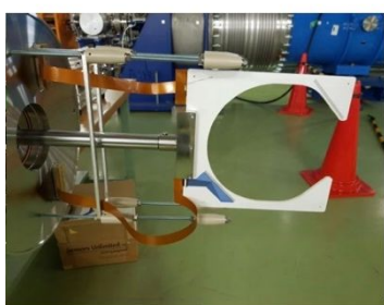
Figure 4 ワイヤ型プロファイルモニターと測定したビームプロファイル。
