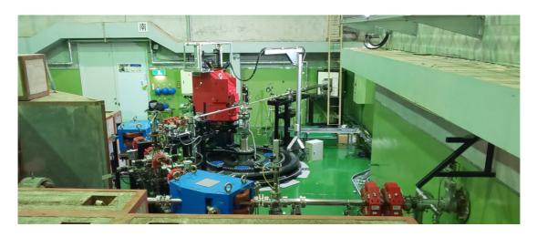
その後、加速器からの電子ビームを供給し、要求されるビーム性能(運動量分解能 0.1%以下、標的上でのビームサイズ 1mm φ以下)が得られていることを確認した。また極薄金標的からの弾性散乱事象を利用し、電磁石スペクトロメータが計算通りに焦点面が形成されていることを確認後、運動量分散、分解能などの光学性能も設計通り実現されていることを確認した。
