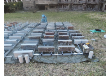
写真1 屋外暴露試験(軍艦島)
