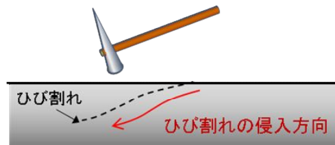
図 1. 斜めひび割れの深さ推定
