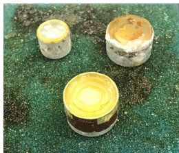
図1. 経年劣化したLiI:Euシンチレーターの 外観
