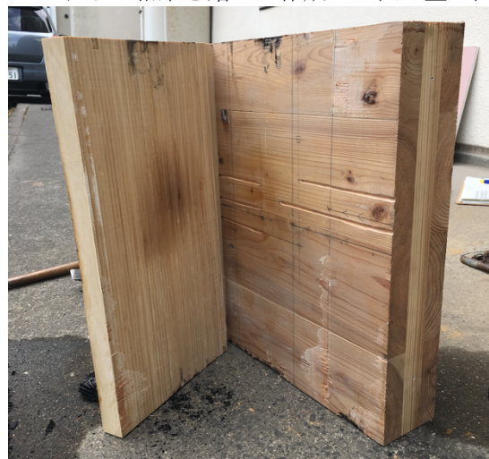
図4 竹の集成材を用いた試験体：加熱後の CLT 表面
