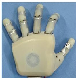
図 3 開発したスピーカ搭載手部
