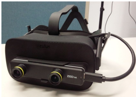
図3 外部ステレオカメラを装着したHMD
