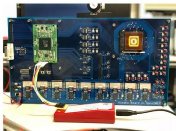
図 3 試作イメージセンサの評価ボード
