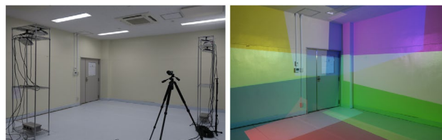
(a) 投影空間の概観 (b) プロジェクタの投影領域 図10 6台プロジェクタによる室内空間への投影環境
