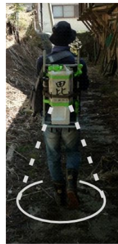
図5 . 開発する歩行用 ASURA システムのイメージ。測定者の真下の狭い範囲 (図中の白丸程度) からのガンマ線だけに感度を持ち、その範囲の沈着量を求める事が出来る。
