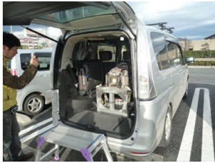
図2 . 調査用自動車に搭載した ASURA の写真。
