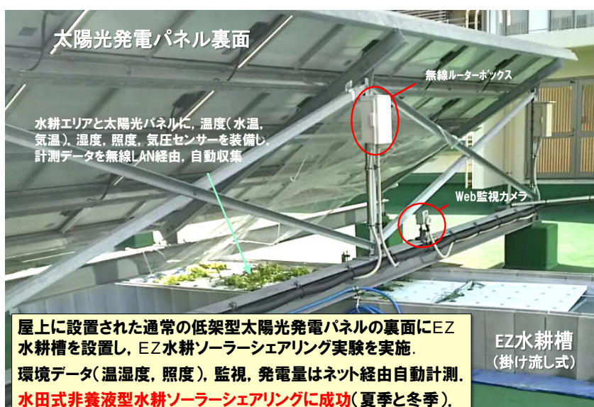
(図 5) 自動計測・監視システムを備えた低架型水田式水耕ソーラーシェアリング実験設備
