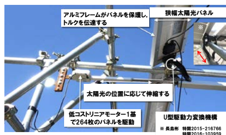
(b) 簡易型一軸太陽光自動追尾機構
