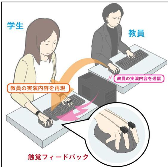
図2：ソレノイドを用いた軽量小型の触覚提示デバイス概念図
