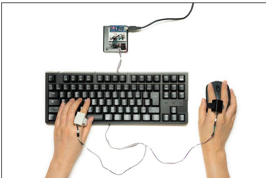
図4：触覚によるPC教示支援システムSZFOXの外観
