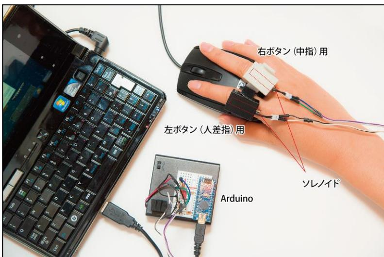
図3：触覚によるマウス操作伝達システム SZCAT の外観
