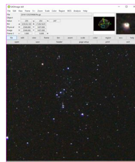
画像上：FITS形式の画像をds9にて表示した例。冬のオリオン座が表示されている。gzipにて圧縮されたFITS画像を出力可能としネットワーク負荷に配慮している。
