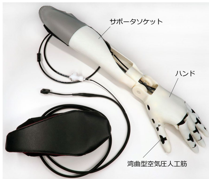
図2 湾曲型空気圧人工筋を用いた5指義手
