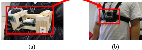
図1. 実験装置：(a) 自己装着カメラと9軸センサ付実験装置, (b) ウェアラブル歩行姿勢推定装置
