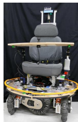
図4 操作支援機能を搭載した全方向移動支援機器
