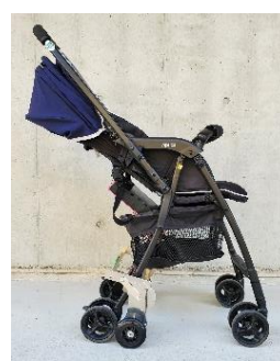
(b) 電動化装置を取り付けたバギー
