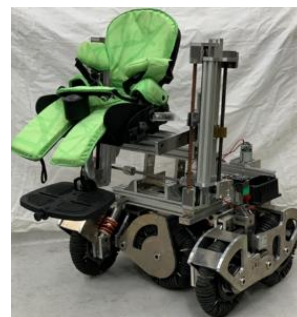
図3 座面昇降機能を搭載した全方向移動支援機器
