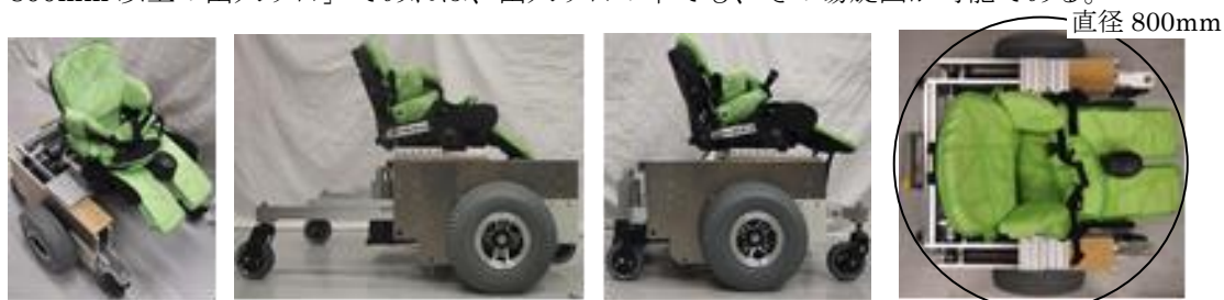
(a) 全体図 (b) 前輪駆動 (c) 中輪駆動 (d) 中輪駆動(平面図)
