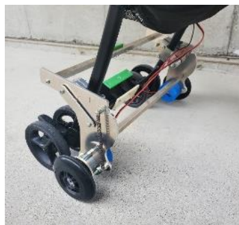
(a) 電動化装置の取り付け状態
