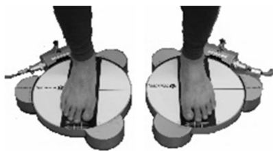
図4 新型ジャイロ・メディメータ 回旋円盤部の周囲3か所にある耳型の突出部に荷重センサーが組み込まれている。
