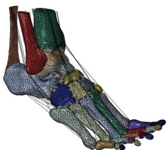
図 1 足部の内部構造を考慮した有限要素モデル
